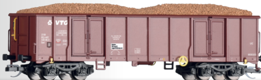
Offener Güterwagen Eaos der VTG, beladen mit Rüben Open car Eaos of the VTG with load
